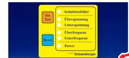
Höchstmögliche Sicherheit bei Inbetriebnahme. Innovative Technologie sinnvoll eingesetzt:
