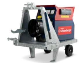
Hinter der roten Abdeckung sind die Messgeräte und Steckdosen besonders geschützt. Überdies wird durch das Gehäuse die Kühlbluft zur Getriebekühlung verwendet. Das spezielle Luftführungssystem erlaubt 100 % Dauerlast ohne Überhitzung.
