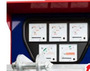
Hinter einem Schutzglas liegen die 96 mm x 96 mm großen, beleuchteten analogen Messgeräte, zusätzlich noch abgeschirmt. Ideal vom Traktor aus sichtbar.
