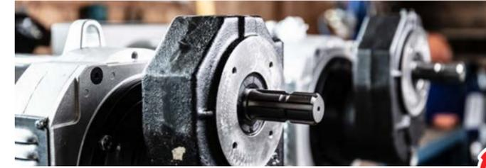
Das schrägverzahnte Getriebe hat gehärtete Zahnräder, die im Ölbad laufen. Umgeben ist es von einem Gehäuse aus Grauguss, um höchsten Qualitätsansprüchen zu genügen. Auf der Zapwellenseite ist ein 1-3/4"-Z20-Stummel.
