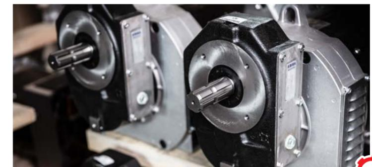
Mit einem 4-poligen, innenbelüfteten Synchrongenerator mit 1500 min<sup>-1</sup>, zudem noch bürstenlos, ist das Gerät überaus wartungsarm und dank einer elektronischen Spannungsregelung sehr präzise (+/-1 % 400 V Konstanzspannung).
