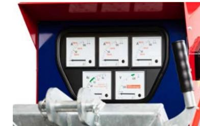
Hinter einem Schutzglas liegen die 96 mm x 96 mm großen, beleuchteten analogen Messgeräte, zusätzlich noch abgeschrägt. Ideal vom Traktor aus sichtbar.
