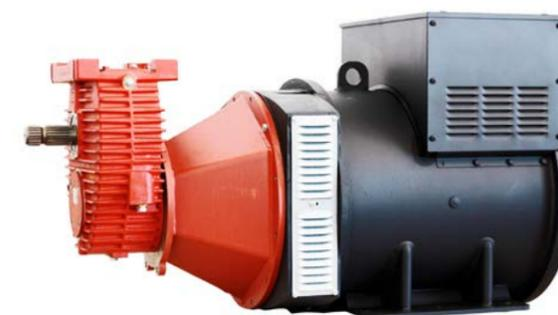
Mit einem 4-poligen, innenbelüfteten Synchron-generator mit 1500 min<sup>-1</sup>, zudem noch bürstenlos, ist das Gerät überaus wartungsarm und dank einer elektronischen Spannungsregelung sehr präzise (+-1 %).
